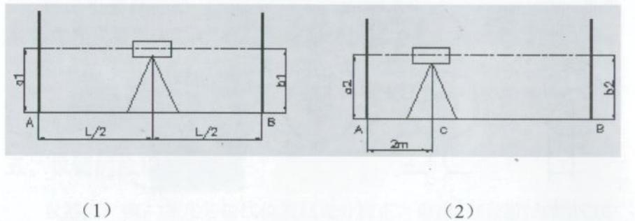
在A、B二点设置标尺，用仪器瞄准标尺并读取读数a<sub>1</sub>、b<sub>1</sub>。
